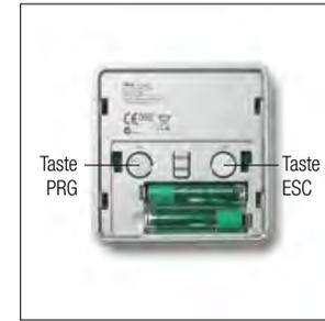
Intuitives Programmierverfahren dank der Tasten an der Senderrückseite
