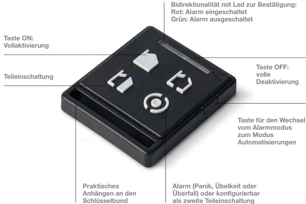
**Funksender 8 Kanäle, bidirektional
