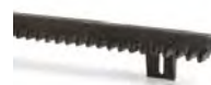
ROA6 Nylonzahnstange M4, 25 x 20 x 1000 mm, mit Schlitz und Metalleinsatz. Für Tore mit einem max. Gewicht von 500 kg. St./Pckg. 10
