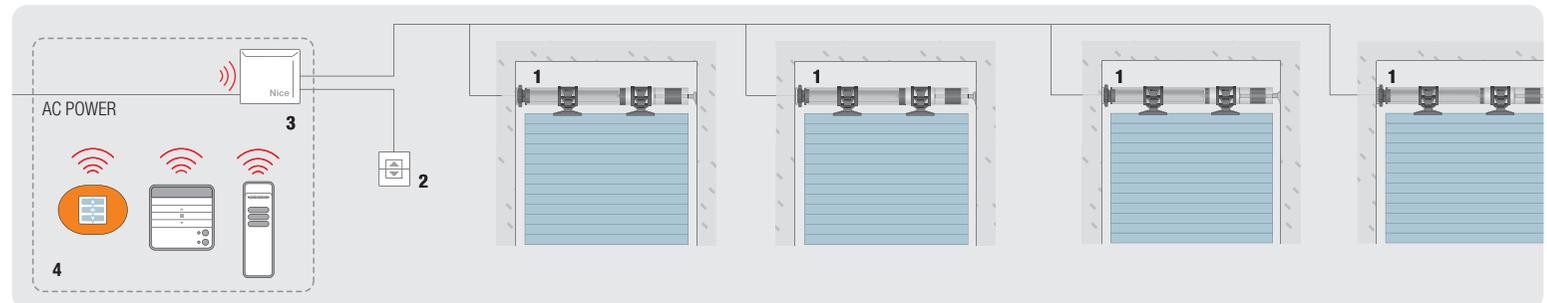
1.ROHRANTRIEB 2. „AUF-/AB“-TASTE FÜR GRUPPENBEDIENUNG 3. STEUERGERÄT BAUREIHE MINDY TT4\* 4. SENDE R FÜR GRUPPENBEDIENUNG
