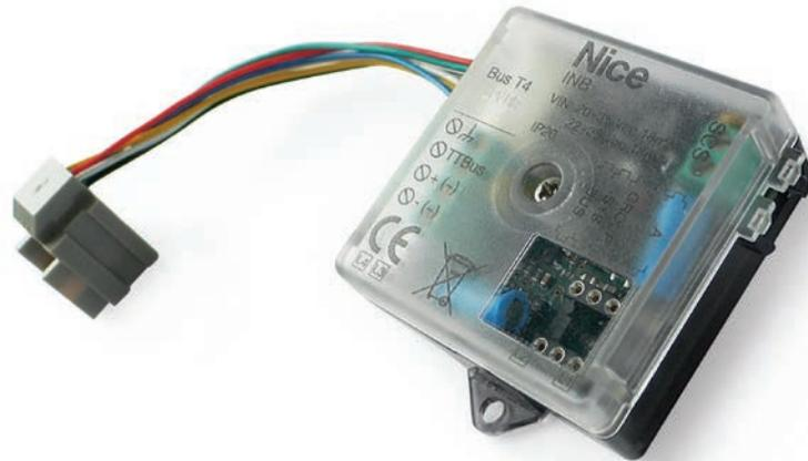
**INB ist eine Nice-Steuerschnittstelle, die die Kommunikation zwischen den Nice-Bus-Systemen (TTBus und BusT4) und MyHome von BTicino (SCS) herstellt.**
