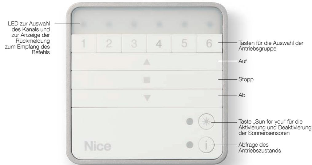
**Sender erhältlich in der Ausführung mit 1 und 6 Kanälen für die Steuerung von bis zu 6 Antriebsgruppen einzeln, gruppenweise oder als Mehrfachgruppe, auch mit separater Aktivierung der Wettersensoren.**
